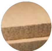
La laine de bois en panneaux rigides se présente sous la forme de fibre de bois à très forte densité (110 à 250 kg/m<sup>3</sup>) ce qui la destine tout particulièrement à l'isolation par l'extérieur. Les fibres se lient entre elles par des liaisons naturelles lors du rapprochement des fibres par séchage et par pression, ce qui en fait un matériau sans liant synthétique.
