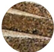
Le panneau de liège expansé est un isolant fabriqué à partir de granulés de liège qui, sous l'effet de la vapeur surchauffée, se transforment en blocs grâce à leur propre résine. Ce matériau isolant offre un excellent déphasage.
