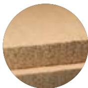
Le panneau de laine est appelé ainsi car il est souple, ou semi-rigide. Composé de bois recyclé, ces panneaux font de 30 à 55 kg/m<sup>3</sup>. Ils s'adaptent bien aux irrégularités et sont très utilisés pour isoler murs et toit entre chevrons ou en caisson.
