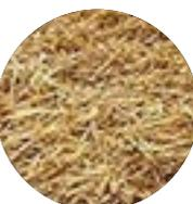
Les bottes de paille peuvent être utilisées comme matériau d'isolation. La résistance thermique de l'élément est déterminé en fonction de l'épaisseur et du sens de pose. La mise en oeuvre doit être réalisée par un personnel qualifié aux pratiques décrites dans les Règles Professionnelles de construction paille.
